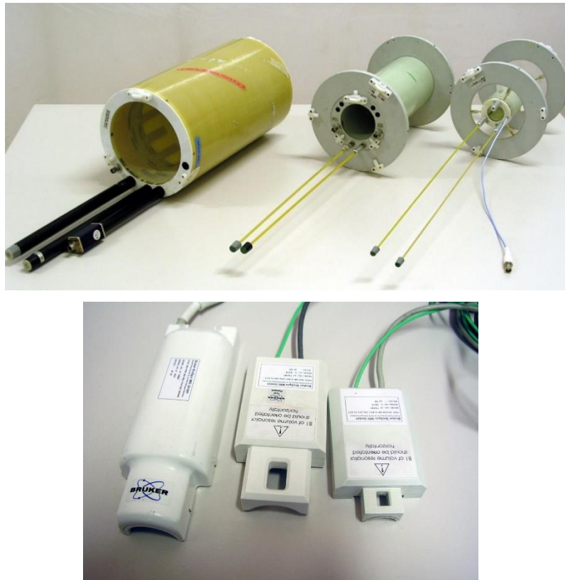
Figura 2.15a-b. In alto (a) le bobine di volume utilizzate in laboratorio, da sinistra rispettivamente di 15.4 cm di diametro, 7.2 cm e 3.5 cm. In basso (b) le bobine di superficie adatte, rispettivamente, per la testa del ratto (le prime due a sx) e per la testa del topo.
