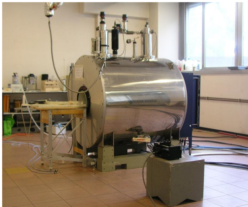
Figura 2.14 Tomografo Bruker Biospec 4.7 T del laboratorio di Risonanza Magnetica (Dipartimento di Neuroscienze, Biomedicina e Movimento) dell'Università di Verona.
