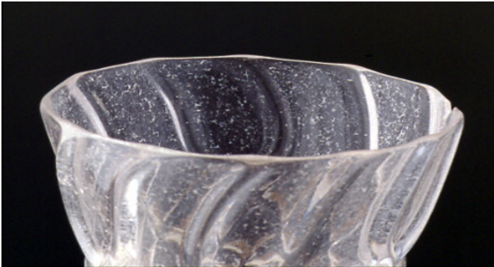
Figura 3 Vetro che piange. Vaso del 18th century Facon de Venice, sulla cui superficie si osserva la formazione di formiati di sodio, prodotti dalla reazione dell'acido formico emesso dal compensato della scaffalatura della vetrina di esposizione.
