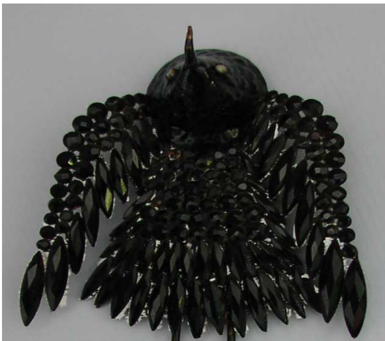
Figura 1. Corrosione della lega piombo stagno usata per la saldatura di un gioiello
