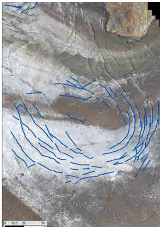
Fig.3: Identificazione e mappatura dei crepacci relativi a una struttura di collasso (ring fault) su una ortofoto del Ghiacciaio dei Forni
